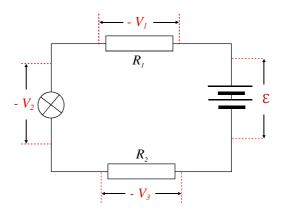
$$E - V_1 - V_2 - V_3 = 0$$
